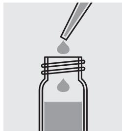
Avec une pipette, ajouter 5,0 ml d'eau désionisée et mélanger.
