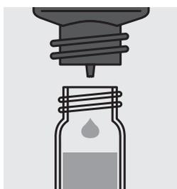
Ajouter 8 gouttes de NH<sub>4</sub>-3, mélanger et fermer le tube au moyen du couvercle fileté.
