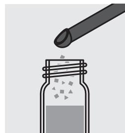
Ajouter 1 microcuiller verte (pleine à ras) de **Cd-3** et fermer le tube au moyen du couvercle fileté.
