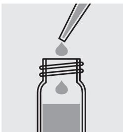
Ajouter 10,0 ml d'échantillon avec une pipette et mélanger.
