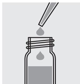
Ajouter 1,0 ml de **Ag-6** avec une pipette, fermer le tube avec le couvercle fileté et mélanger.
