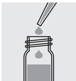
Ajouter 1,20 ml NH<sub>4</sub>-1 avec une pipette et mélanger.
