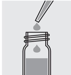
Ajouter 2,5 ml **Cl-1** au moyen d'une pipette et mélanger.
