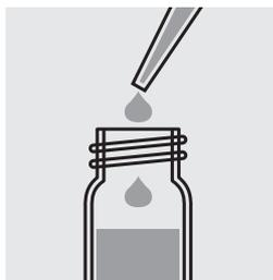
Avec une pipette, ajouter avec précaution 1,5 ml d'échantillon, fermer le tube au moyen du couvercle fileté et mélanger.
