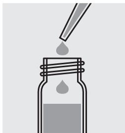
Pipeter 1,0 ml d'échantillon dans un tube de réaction et mélanger.
