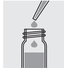
Ajouter 5,0 ml d'échantillon au moyen d'une pipette et mélanger.
