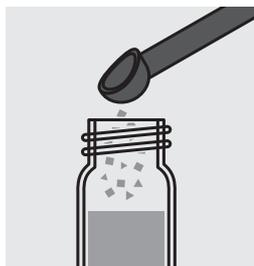
Ajouter 1 microcuiller bleue de Cl<sub>2</sub>-1 (remplie à ras) et fermer le tube au moyen du couvercle fileté.
