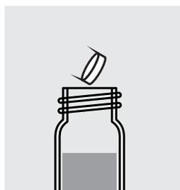
Ajouter 1 comprimé de **ALKA-M-PHOTOMETER** directement à partir du film, écraser avec une baguette d'agitation propre et fermer avec le bouchon fileté
