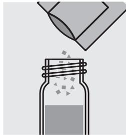
Ajouter le contenu d'un sachet de poudre de **VARIO Iron TPTZ F10** et fermer le tube avec le couvercle fileté.
