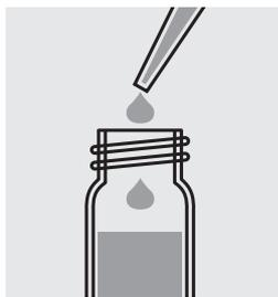
Immédiatement, ajouter 1,5 ml **NO<sub>3</sub>-2** avec une pipette fermer le tube au moyen du couvercle fileté.
