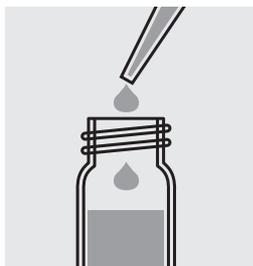
Pipeter 5,0 ml d'échantillon dans un tube de réaction et fermer le tube au moyen du couvercle fileté.
