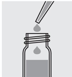
Ajouter 0,60 ml de **NH<sub>4</sub>-1** avec une pipette et mélanger.
