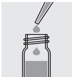
Avec une pipette, ajouter 1,0 ml de **H-1K**, fermer le tube avec le couvercle fileté et mélanger.
