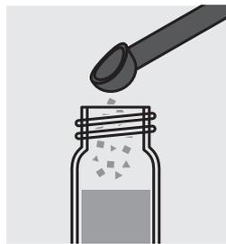
Ajouter 1 cuiller de mesure noire numéro 8 (pleine à ras) de **Nitrit-101** et fermer le tube au moyen du couvercle fileté.
