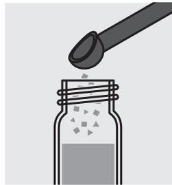
Ajouter 1 cuiller de mesure noire numéro 8 (pleine à ras) de **Nitrit-101** et fermer le tube au moyen du couvercle fileté.
