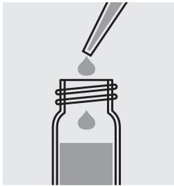
Pipeter **avec précision** 2,0 ml d'échantillon dans le tube, le fermer au moyen du couvercle fileté et mélanger vigoureusement.
