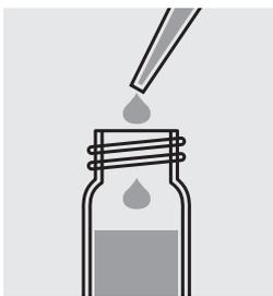
Pipeter 0,50 ml **Zn-2K** dans un tube de réaction, fermer avec le couvercle fileté et mélanger.
