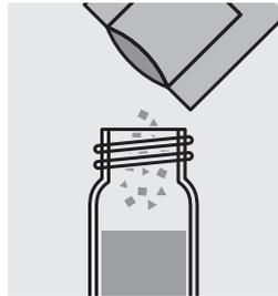
Ajouter 1 sachet de poudre de **Molybdenum HR2**, fermer le tube avec le couvercle fileté et dissoudre la matière solide.
