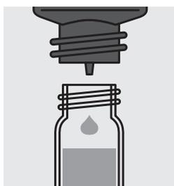
Ajouter 1 goutte de **Free Ammonia Reagent**, fermer le tube avec le couvercle fileté et mélanger.
