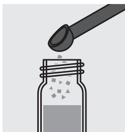
Ajouter 1 microcuiller bleue de **K-2K** (remplie à ras) et fermer le tube au moyen du couvercle fileté.
