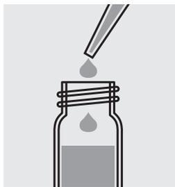
Avec une pipette, ajouter très lentement 1,5 ml d'échantillon préparé, fermer avec le couvercle fileté et mélanger vigoureusement. **Attention, le tube devient très chaud!**
