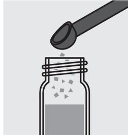
Ajouter 2 microcuillers bleues de Cl<sub>2</sub>-1 (remplie à ras) et fermer le tube au moyen du couvercle fileté.
