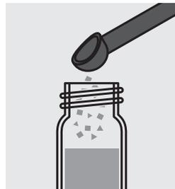
Ajouter 1 microcuiller bleue de **NH<sub>4</sub>-2** (remplie à ras) et fermer le tube au moyen du couvercle fileté.
