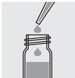
Pipeter **avec précaution** 0,10 ml d'échantillon dans le tube, le fermer au moyen du couvercle fileté et mélanger vigoureusement.
