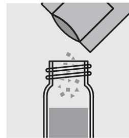
Ajouter le contenu d'un sachet de poudre de réactif **VARIO Molybdenum HR2 F10** et fermer le tube avec le couvercle fileté.
