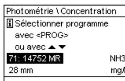
Commuter sur le mode de mesure *Photométrie* et sélectionner le numéro de programme 71.
