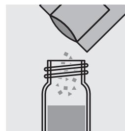
Ajouter le contenu d'un sachet de poudre de **VARIO Silica Citric Acid F10** et fermer le tube avec le couvercle fileté.
