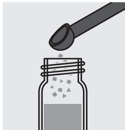
Ajouter 2 microcuillers bleues (pleines à ras) de **NO<sub>2</sub>-1** et fermer le tube avec le couvercle fileté.
