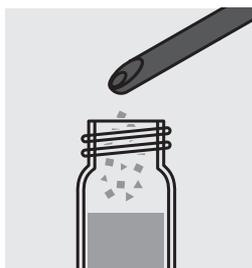
Ajouter 1 microcuiller grise (pleine à ras) de **Ph-1K** et fermer le tube au moyen du couvercle fileté.
