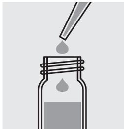
Ajouter 0,50 ml d'échantillon, fermer le tube au moyen du couvercle fileté et mélanger.
