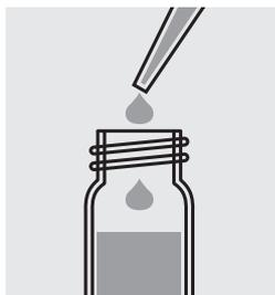
Pipeter 0,50 ml d'échantillon dans un tube de réaction et mélanger.
