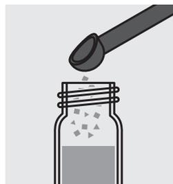
Ajouter 1 microcuiller bleue de O<sub>3</sub>-2 (remplie à ras) et fermer le tube au moyen du couvercle fileté.
