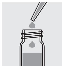
Ajouter 10,0 ml d'échantillon avec une pipette et fermer le tube.
