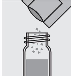
Ajouter le contenu d'un sachet de poudre **Monochlor F RGT** et fermer le tube avec le couvercle fileté.
