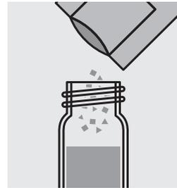
Ajouter 1 sachet de poudre de **Molybdenum HR3** et fermer le tube avec le couvercle fileté.
