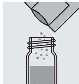
Ajouter le contenu d'un sachet de poudre de **Phosphate RGT F10 ml** et fermer le tube avec le couvercle fileté.
