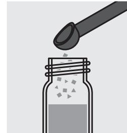
Ajouter 1 microcuiller bleue de ClO<sub>2</sub>-2 (remplie à ras) et fermer le tube au moyen du couvercle fileté.
