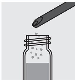
Ajouter 2 microcuillers grise de **NO<sub>3</sub>-3** (remplie à ras) et fermer le tube au moyen du couvercle fileté.
