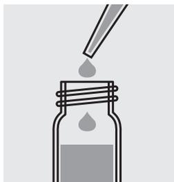
Ajouter 0,50 ml de **Si-3** avec une pipette, fermer le tube avec le couvercle fileté et mélanger.
