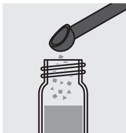
Ajouter 1 microcuiller bleue de **NH<sub>4</sub>-2** (remplie à ras) et fermer le tube au moyen du couvercle fileté.
