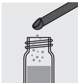
Ajouter 1 microcuiller verte de **Ag-2** (remplie à ras) et fermer le tube au moyen du couvercle fileté.
