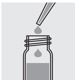
Ajouter 0,50 ml de **AC-2** avec une pipette, fermer avec le couvercle fileté et mélanger.
