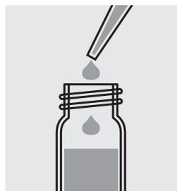
Avec une pipette, ajouter 2,0 ml d'**échantillon préparé**, fermer avec le couvercle fileté et mélanger.
