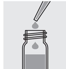
Ajouter 5,0 ml d'échantillon avec une pipette, fermer avec le couvercle fileté et mélanger.
