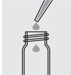
Procéder au réglage du zéro avec une tube de 28 mm et de l'échantillon.
