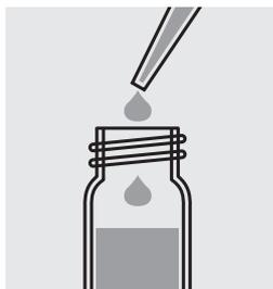
Avec une pipette, ajouter 1,0 ml de **Mg-1K**, fermer le tube avec le couvercle fileté et mélanger.
