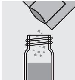
Ajouter le contenu d'un sachet de poudre de **VARIO Manganese Citrate Buffer** et fermer le tube avec le couvercle fileté.
