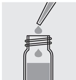
Pipeter 5,0 ml d'échantillon dans un tube de réaction, fermer le tube au moyen du couvercle fileté et mélanger.
