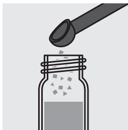
Verser 1 microcuiller de **NO<sub>3</sub>-1K** (remplie à ras) dans un tube de réaction et fermer le tube au moyen du couvercle fileté.
