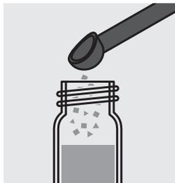
Ajouter 2 microcuillers bleues (pleines à ras) de **NH<sub>4</sub>-2** et fermer le tube au moyen du couvercle fileté.
