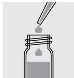
Pipeter 2,0 ml d'échantillon préparé dans un tube à réaction **Total Nitrogen Acid LR Tube (Reagent C)** et fermer le tube avec le couvercle fileté.
