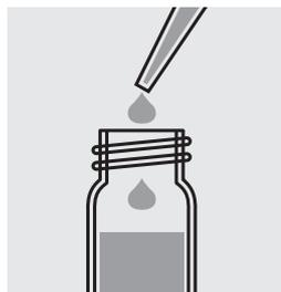
Pipeter 5,0 ml d'échantillon dans un tube de réaction et mélanger.
