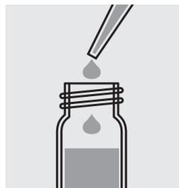
Ajouter 8,0 ml d'échantillon au moyen d'une pipette, fermer le tube au moyen du couvercle fileté et mélanger.
