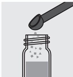
Ajouter 1 microcuiller bleue de **CN-3K** (remplie à ras) et fermer le tube au moyen du couvercle fileté.
