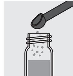
Ajouter 1 microcuiller bleue (pleine à ras) de **PO<sub>4</sub>-2** et fermer le tube avec le couvercle fileté.
