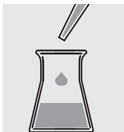
Ajouter 1,0 ml de **As-6** à la pipette à la solution dans l'erlenmeyer et mélanger.
