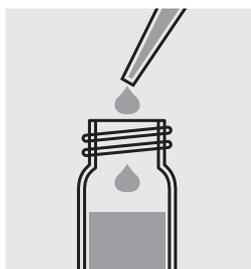
Ajouter 1,0 ml d'échantillon avec une pipette, fermer avec le couvercle fileté et mélanger.
