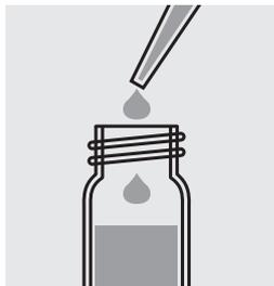
Pipeter 0,50 ml **Na-1K** dans un tube de réaction et mélanger.
