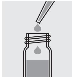
Ajouter 1,0 ml d'échantillon au moyen d'une pipette, fermer le tube au moyen du couvercle fileté et mélanger.
