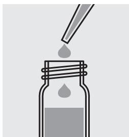
Avec une pipette, ajouter 2,0 ml de solution d'hydroxyde de sodium 1,54 N, fermer le tube avec le couvercle fileté et mélanger le contenu en retournant le tube avec précaution.
