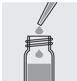
Pipeter 5,0 ml d'échantillon dans un tube de réaction.
