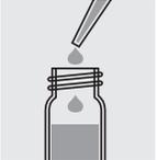
Pipeter **avec précaution** 3,0 ml d'échantillon dans le tube, le fermer au
