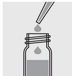
Ajouter 15 gouttes de solution de **VARIO Alkaline-Cyanide Reagent Solution** et fermer le tube avec le couvercle fileté.
