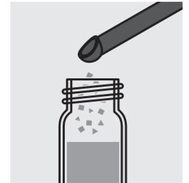
Ajouter 1 microcuiller bleue (pleine à ras) de **SO<sub>4</sub>-2** et fermer le tube avec le couvercle fileté.
