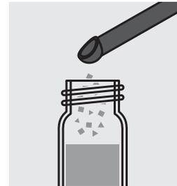
Ajouter 1 microcuiller verte (pleine à ras) de **SO<sub>4</sub>-1K** et fermer le tube avec le couvercle fileté.
