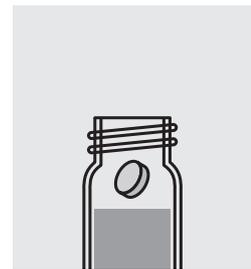
Ajouter 1 comprimé **Cyanuric Acid**, écraser avec la baguette d'agitation propre et fermer avec le couvercle fileté.
