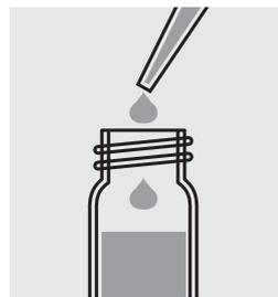
Ajouter avec une pipette 2,0 ml de **Sodium hydroxide 1,00 N**, fermer le tube au moyen du couvercle fileté et mélanger.
