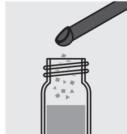
Ajouter 1 microcuiller verte (pleine à ras) de **Cd-2K** et fermer le tube au moyen du couvercle fileté.
