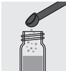
Verser 1 microcuiller de **N-3K** (remplie à ras) dans un tube de réaction et fermer le tube au moyen du couvercle fileté.
