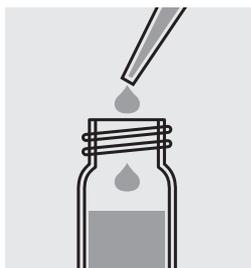
Avec une pipette, ajouter avec précaution 2,0 ml d'échantillon, fermer le tube au moyen du couvercle fileté et mélanger.
